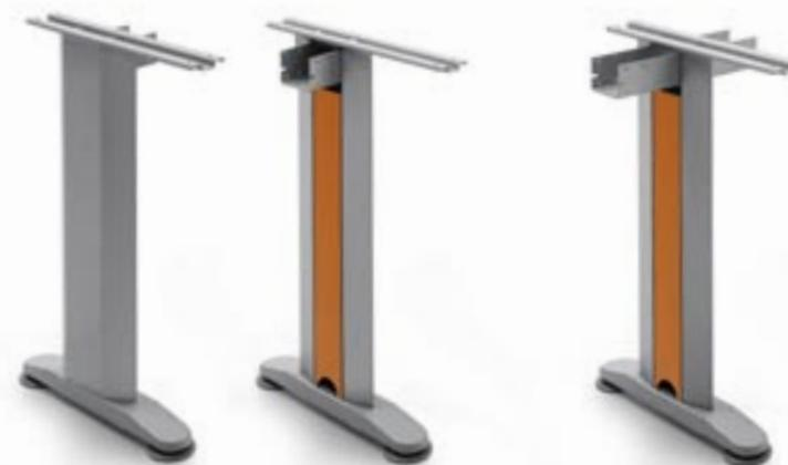
La gamba a "T" di profondità 60 cm è predisposta per il fissaggio del piano e della trave. Nella parte interne prevede un carter in lamiera removibile. E' realizzata in lamiera di acciaio opportunamente rinforzata e sagomata. *(Nel caso di gamba centrale prevede il fissaggio delle travi da entrambi i lati).*
